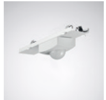
IS 3360 MX Highbay • DALI-2 Input Device • Montagehöhe max. 14 m • Reichweite tangential Ø 36 m
