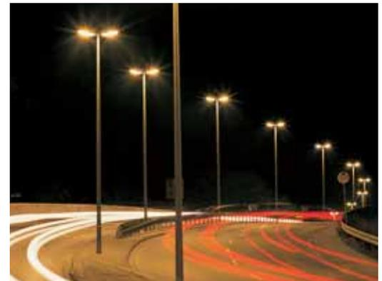
Helle Fahrbahnmaterialien (z. B. mit Quarzanteilen) weisen hohe, dunkle Fahrbahnmaterialien (z. B. mit dunklen mineralischen Füllstoffen) niedrige mittlere Leuchtdichtekoeffizienten  $q_0$  auf. Die Werte von  $\chi_p$  und  $q_0$  können sich im Laufe der Nutzung der Fahrbahn durch Reifenabrieb, Ölschichten, Verschmutzungen, Feuchtigkeit usw. erheblich ändern.
