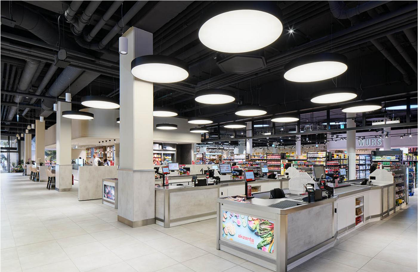
Au rayon surgelés, des Lightpanels dans une température de couleur plus froide (4000K) sont fixés sur des rails d'alimentation. Les grands luminaires suspendus ronds Loreto créent un effet de profondeur et facilitent l'orientation des clients vers la zone de caisses.
