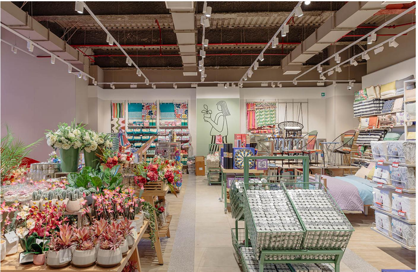
Die Gestaltung des Stores basiert auf offenen Strukturen mit fließenden Übergängen zwischen den Bereichen. Um diesen Eindruck architektonisch und visuell zu verstärken, setzte TRILUX auf einen Mix aus abgehängten Stromeisenstrahlern, Einbaustrahlern, linearen Lichtsystemen und zurückhaltend integrierten Wallwashern. Ziel war es, ein homogenes, aber differenziertes Lichtbild zu erzeugen, das Texturen, Farben und Materialien akzentuiert zur Geltung bringt.
