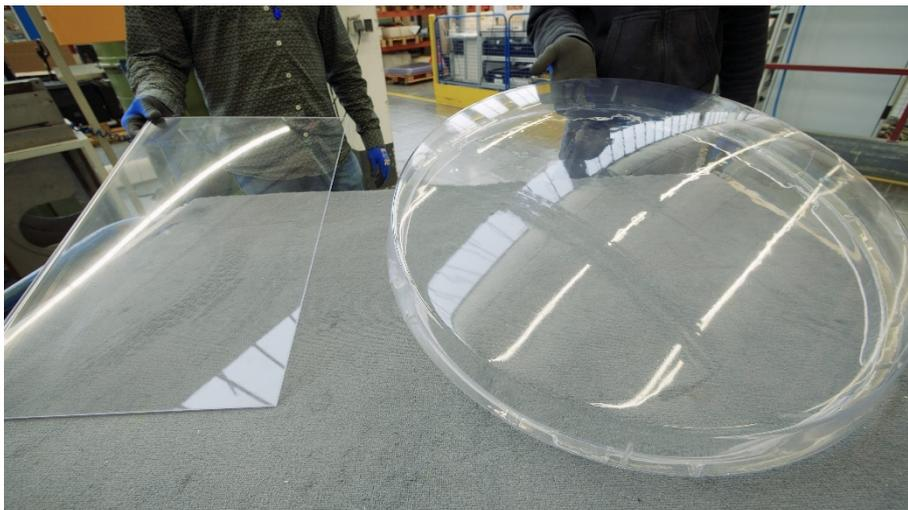
Bild: Leuchtenabdeckungen aus recyceltem Material
