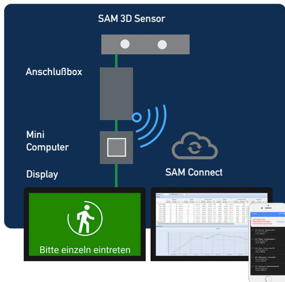
Der SAM 3D Sensor für den Personenfüllstand kann in Höhen von 2,4 m - 7 m installiert werden und deckt je nach Montagehöhen Eingangsbreiten von 2,8 m - 12 m ab.
