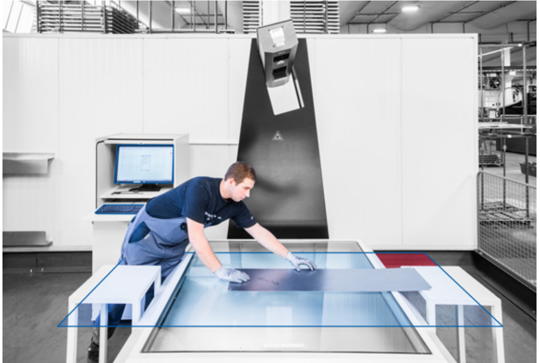
Abbildung 4.7: Qualitätskontrolle von Blech-Werkstücken mit dem Laserscanner: Ausrichten des Werkstückes (horizontale Sehaufgabe, T1) und Überprüfung der Maßhaltigkeit am Bildschirm (T2).
