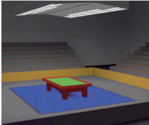
Abbildung 4.34: Beispiel für die Beleuchtung eines Snooker-Spielbereiches für hohes Wettbewerbsniveau mit 750 lx auf der Referenzfläche, realisiert mit 26 opalen Wannenleuchten, LED, 4.500 lm
