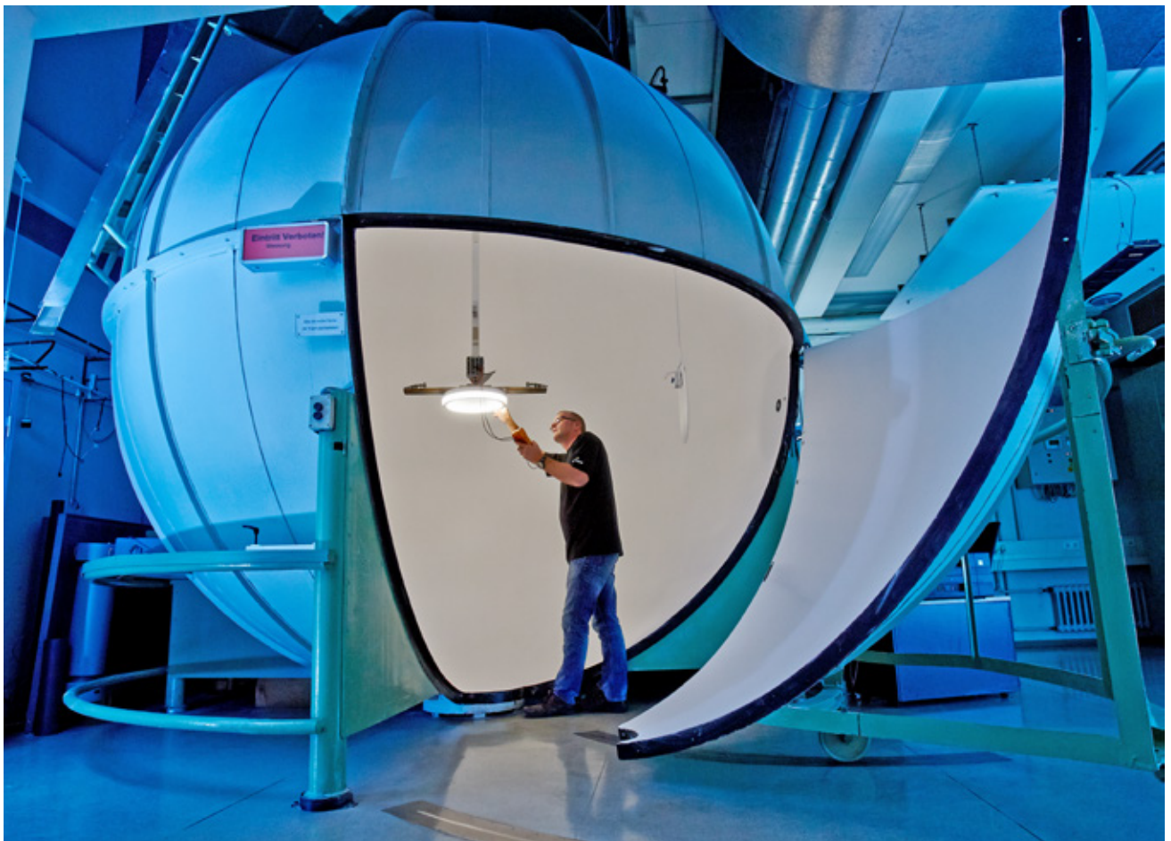
Abbildung 5.11: Ulbrichtsche Kugel zur Messung von Lichtströmen von austauschbaren Lichtquellen und Leuchten. Der Lichtstrom der Leuchte \phi_L dividiert durch den Lichtstrom der eingesetzten Lichtquellen \phi_0 , ergibt ggf. den Leuchtenbetriebswirkungsgrad.
