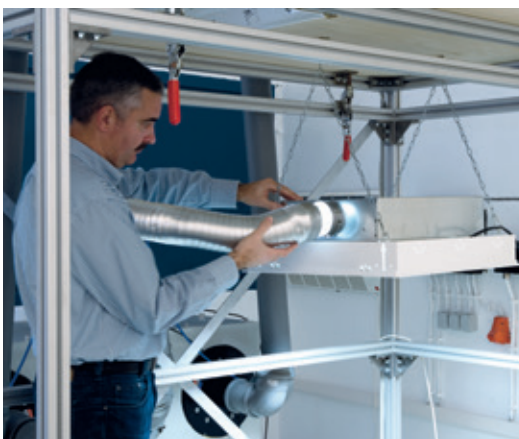
(c) Blick in den Hallraum: Eine Abluftleuchte für den Einbau in die Unterdruckdecke wird zur Messung vorbereitet.
