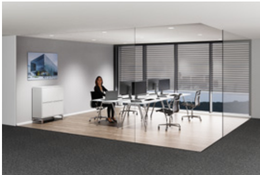
(a) Büroraum mit Downlights, bei 4.000 K \bar{E}_h im Arbeitsbereich: 703 lx E_v am Arbeitsplatz: 324 lx a_{meL,v} am Arbeitsplatz: 0,56 MEDI(32) am Arbeitsplatz: 324 \text{ lx} \cdot 0,56 \cdot 1,104 \cdot 1 = 200 \text{ lx}_{MEDI} MEDI(50) am Arbeitsplatz: 324 \text{ lx} \cdot 0,56 \cdot 1,104 \cdot 0,66 = 132 \text{ lx}_{MEDI}
