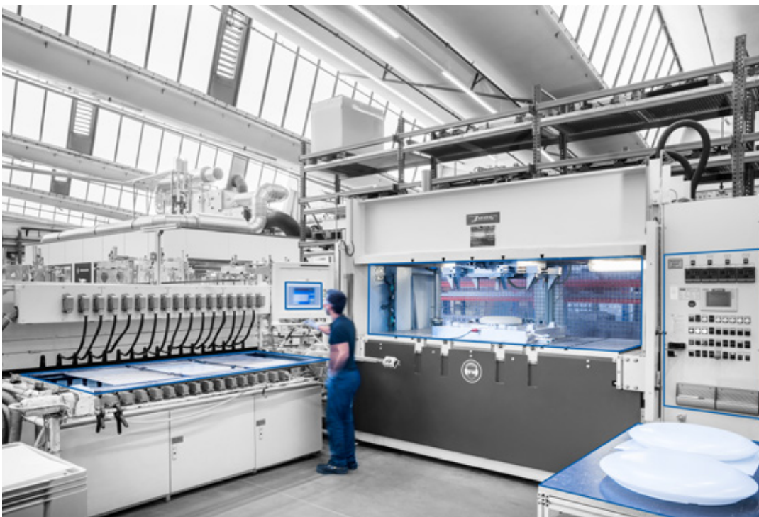
Abbildung 4.6: Arbeitsplatz mit unterschiedlichen Sehaufgaben: Einlegen und Entnehmen von extrudierten PMMA-Platten am Strahlungssofen (T1), Tiefziehen der Werkstücke (T2), Nachbearbeitung und Qualitätskontrolle (T3).
