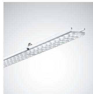
Abbildung 3.24: ArimoFit Kenndaten: Lichtstrom: 8.400 lm Lebensdauer: min. 70.000 h Umgebungstemperatur: 45 °C Schutzart: IP20 Anschlussleistung: 47 Watt Gesamtgewicht: 3,24 kg 1.489,706 kg CO 2 e
