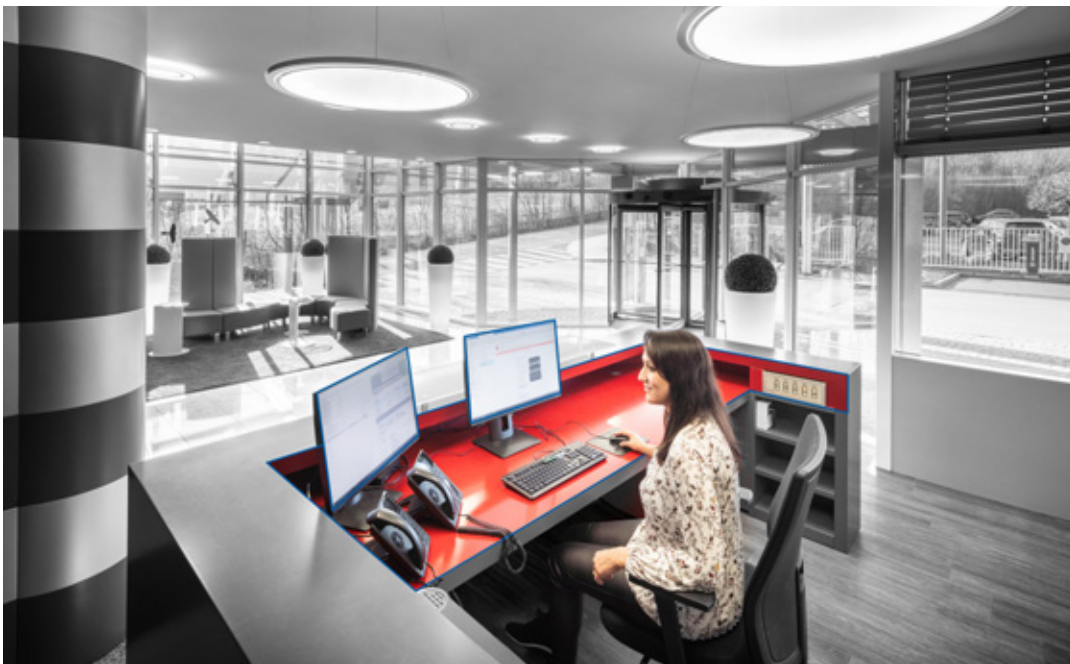
Abbildung 2.4: Büroarbeitsplatz am Empfang mit horizontalen Sehaufgaben auf der Tischfläche und vertikalen Sehaufgaben an den Bildschirmen. Zusätzlich ist ein weiträumig ausgewogenes Verhältnis der horizontalen zur vertikalen Beleuchtungsstärke (Modelling) im Kommunikationsbereich vor und hinter dem Empfangstisch erforderlich.
