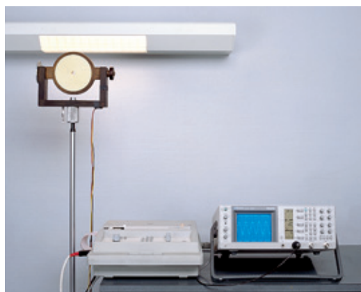
Abbildung 4.43: Elektrokardiograph mit Norm-Mess-Spule zur Messung der magnetischen Induktion einer Krankenzimmer-Installations-einheit
