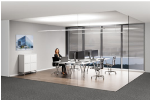
(c) Büroraum mit arbeitszonal angeordneten Hängeleuchten, direkt-indirekt strahlend, bei 4.000 K \bar{E}_h im Arbeitsbereich: 1.258 lx E_v am Arbeitsplatz: 1.013 lx a_{meL,v} am Arbeitsplatz: 0,56 MEDI(32) am Arbeitsplatz: 1.013 \text{ lx} \cdot 0,56 \cdot 1,104 \cdot 1 = 626 \text{ lx}_{MEDI} MEDI(50) am Arbeitsplatz: 1.013 \text{ lx} \cdot 0,56 \cdot 1,104 \cdot 0,66 = 413 \text{ lx}_{MEDI}
