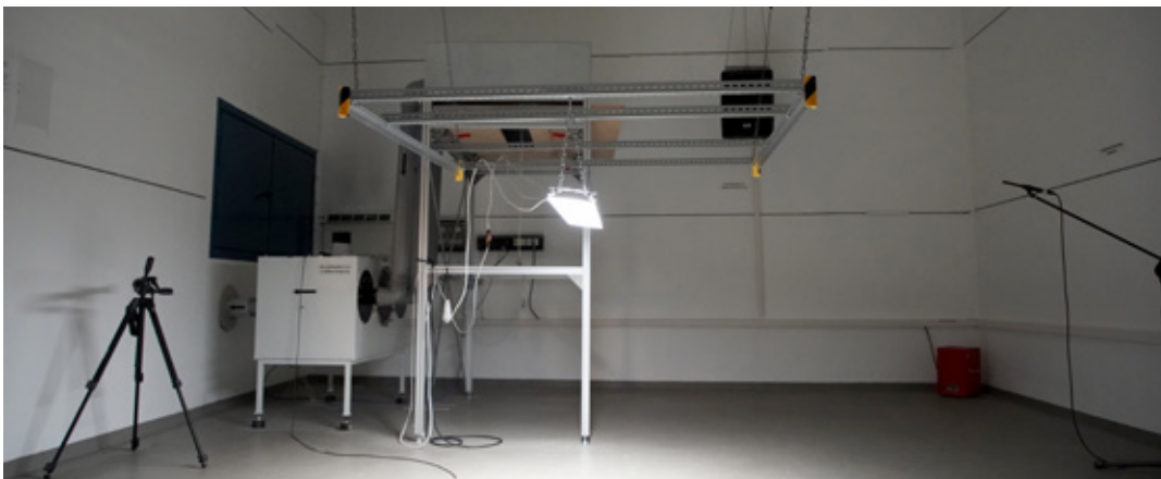
(a) Das Präzisionsmikrophon misst im Hallraum den Schalldruck eventuell auftretender Vibrationsgeräusche von Einbauleuchten.
