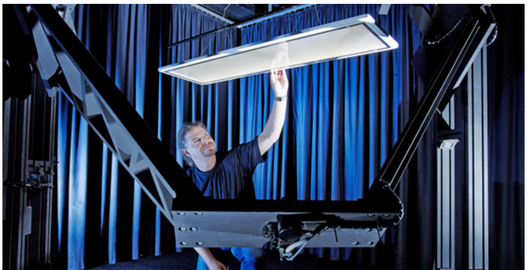
Abbildung 5.25: Messung der Licht- stärkeverteilung mit dem Nahfeldgonio- photometer
