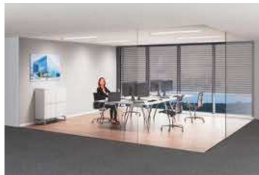
(b) Büroraum mit flächigen Einlegeleuchten, bei 4.000 K \bar{E}_h im Arbeitsbereich: 909 lx E_v am Arbeitsplatz: 380 lx a_{mel,v} am Arbeitsplatz: 0,56 MEDI(32) am Arbeitsplatz: 380 \text{ lx} \cdot 0,56 \cdot 1,104 \cdot 1 = 235 \text{ lx}_{MEDI} MEDI(50) am Arbeitsplatz: 380 \text{ lx} \cdot 0,56 \cdot 1,104 \cdot 0,66 = 155 \text{ lx}_{MEDI}
