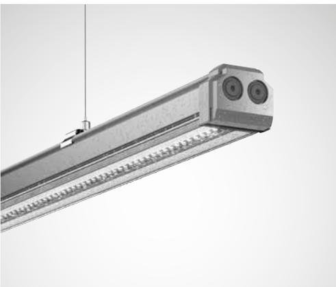
Hart im Nehmen: Die E-Line Fix IP64 ist nicht nur vollkommen staubdicht, sondern auch gegen starkes Spritzwasser von allen Seiten geschützt. Ideal für Bereiche mit hohen Sicherheitsanforderungen oder rauen Rahmenbedingungen. Das Tragprofil kann mit Fix Leuchteneinsätzen kombiniert werden und ist mit Trennstecker-Abständen L150 und L225 in 7LV und 7+7LV erhältlich.
