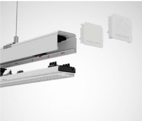
Todos los insertos de luminarias de E-Line Pro están ya «preparados para IP50». El sistema entero cuenta con el grado de protección IP50 gracias a una barra de sellado entre las luminarias, a las juntas de acoplamiento y al cabezal pertinente.
