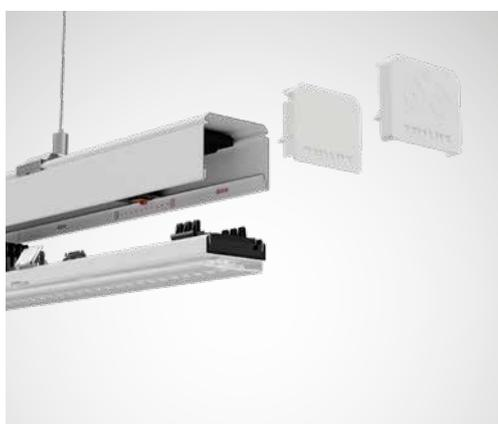
Ogni inserto apparecchio di E-Line Pro è già "IP50 ready"! Grazie a una piastra saldante tra gli apparecchi, a guarnizioni per i giunti di accoppiamento e alla testata terminale giusta, il sistema complessivo si merita il grado di protezione IP50 su tutti i lati.
