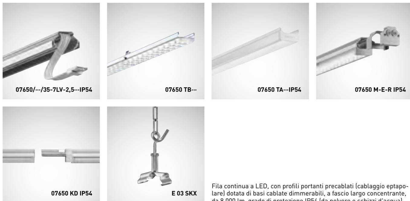
Fila continua a LED, con profili portanti precablati (cablaggio eptapolare) dotata di basi cablate dimmerabili, a fascio largo concentrante, da 8.000 lm, grado di protezione IP54 (da polvere e schizzi d'acqua).
