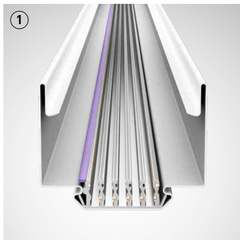
Filerie d'alimentation à 7 conducteurs 5 \times 2,5 \text{ mm}^2 + 2 \times 1,5 \text{ mm}^2 3 circuits électriques séparés 2 câbles de commande pour signal DALI
