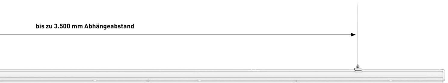
\*Abhängeabstände variieren je nach Art des Leuchteneinsatzes/Moduls. Genauere Angaben entnehmen Sie bitte der Montageanleitung.
