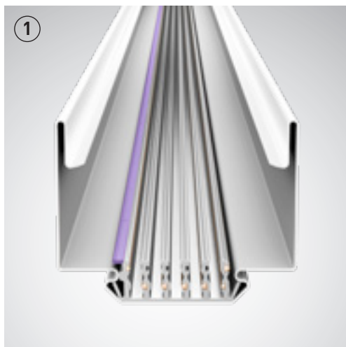
Profilo con cablaggio elettrico a 7 poli 5 x 2,5 mm 2 + 2 x 1,5 mm 2 3 circuiti elettrici separati 2 linee di comando per segnale DALI
