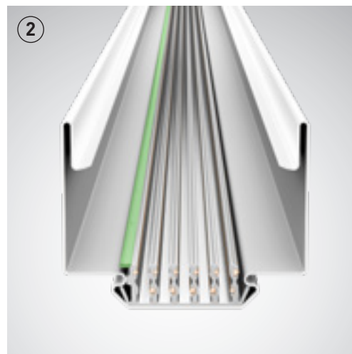
Profilo con cablaggio elettrico a 11 poli 5 x 2,5 mm 2 + 6 x 1,5 mm 2 3 circuiti elettrici separati 2 linee di comando per segnale DALI 2 circuiti indipendenti per illuminazione di emergenza
