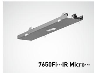
Variables LED Lichtband inklusive Lichtmanagement mit werkseitig verdrahteten Tragprofilen (7-Leiter-Verdrahtung), bestückt mit dimmbaren Geräteträgern, bildschirmarbeitsplatztauglich, Schutzart IP20
