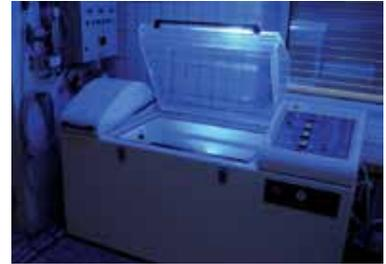
forte résistance aux intempéries. Afin de vérifier de quelle manière le traitement de surface réagit en pratique, TRILUX effectue des tests au brouillard salin. Ici, on étudie les réactions de chaque couche de peinture face au brouillard salin. Grâce à cette préparation, TRILUX fournit des produits résistants aux conditions climatiques spécifiques des environnements marins.
