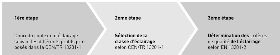
La procédure de détermination des critères de qualité de l'éclairage de rues selon CEN/TR 13201-1 et EN 13201-2 va être expliquée ci-dessous à l'aide d'un exemple :
