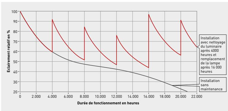
**1.4 Représentation de principe de la baisse de l'éclairage au cours du temps de fonctionnement de l'installation, par ex. lors du nettoyage du luminaire après 4000 heures de fonctionnement.**
