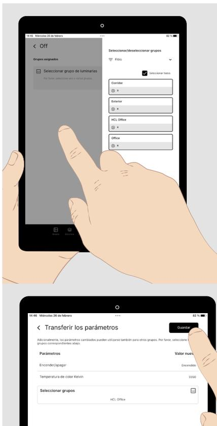
Si varios grupos de luminarias en un escenario de luz deben comportarse de manera idéntica, la parametrización de un grupo puede transferirse a otros grupos de luminarias. Un ejemplo de tal escenario puede ser una **función de apagado central**.
