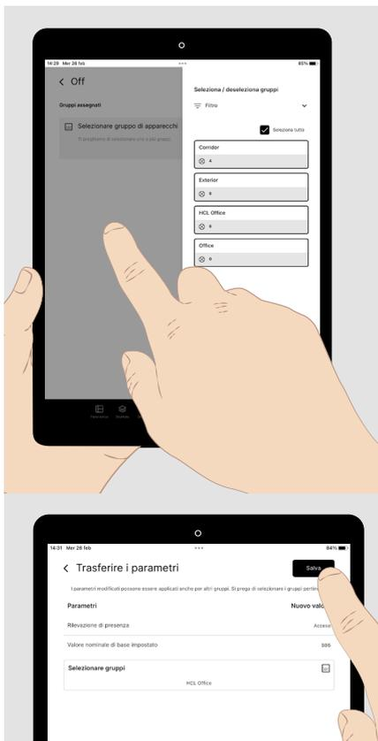
Se in una situazione luminosa si auspica un comportamento identico di più gruppi di apparecchi, la parametrizzazione di un gruppo può essere trasferita a ulteriori gruppi di apparecchi. Un esempio di una situazione luminosa di questo tipo può essere una **funzione di disinserimento** centralizzata.
