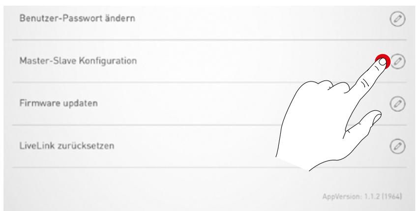
Zuerst sind alle Slave Steuergeräte mit der Slave Betriebsart zu konfigurieren.
