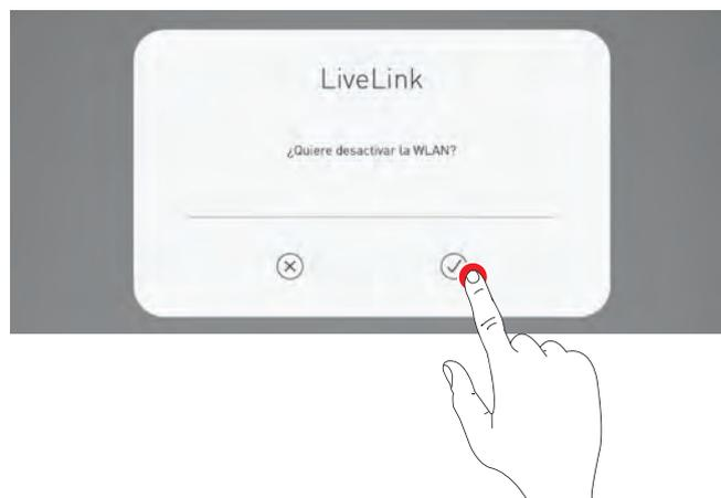
**Aviso:** Entonces, no es posible la conexión directa del dispositivo de mando LiveLink a través de la WLAN; para poder utilizarla de nuevo, el sistema LiveLink debe ser reiniciado.
