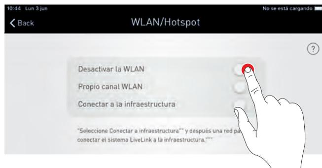
En esta ventana emergente, debe confirmarse la desactivación. A los 10 minutos, la WLAN se apaga.
