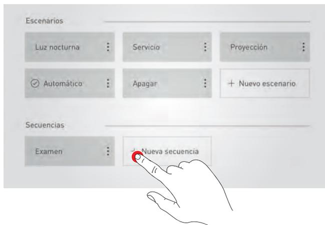
Para ello, primero debe determinarse si se quiere ejecutar la secuencia a través de un inicio automático a una **hora fija o como intervalo de tiempo** con inicio manual - por ejemplo, a través de un pulsador.
