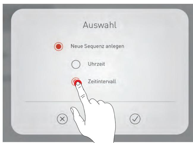
Nel corso di una sequenza, per tutte le situazioni luminose richiamate, le funzioni **funzioni automatiche della regolazione in funzione della luce diurna e della rilevazione di presenza sono disattivate**.
