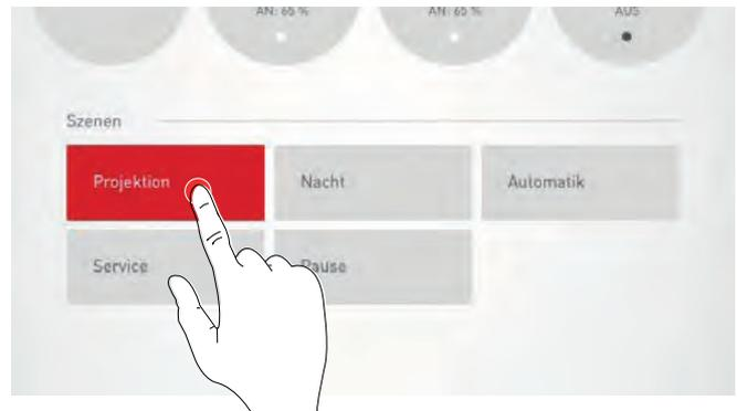
Der aktuelle Beleuchtungszustand der Leuchtengruppen wird angezeigt; die Bedienfelder der manuellen Lichtregelung werden jedoch grau dargestellt. Nach dem Aktivieren einer Beleuchtungsszene oder Sequenz kann unmittelbar ein manueller Eingriff erfolgen; siehe hierzu im Kapitel 2.6 „Verhalten der Lichtsteuerung“.
