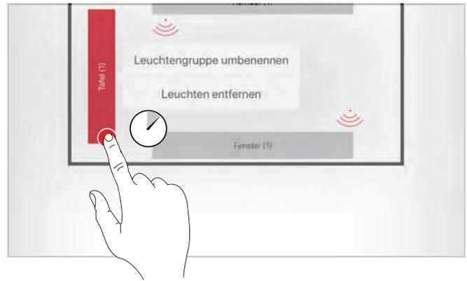
Um Leuchten zu entfernen, werden alle diejenigen im Fenster angezeigt, die dieser Gruppe zugewiesen sind. Durch Antippen können sie einzeln identifiziert und mit anschließendem Tipp auf den Lösch-Button gelöscht werden.
