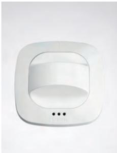
**Überzeugt doppelt auf ganzer Länge.** Der Hochfrequenz-Gangsensor Dual HF eignet sich mit seinem Erfassungsbereich von 20 m x 3 m für lange Gänge. Entscheidend bei einem Gangsensor ist, wie gut radiale Bewegungen erfasst werden. Damit ist die frontale Gehrichtung auf den Sensor gemeint. Die STEINEL-Hochfrequenz-Technologie meistert dies perfekt.
