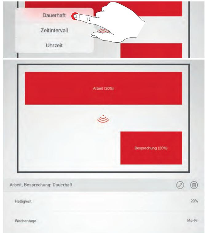
Der Dimmwert für die Grundlicht-Helligkeit beträgt in der Voreinstellung 20%. Mit einem Slider kann die Grundlicht-Helligkeit auf einen Dimmwert zwischen 1% und 60% eingestellt werden. Die Beleuchtung reagiert direkt auf diese Einstellung und kann somit im Raum beobachtet werden.
