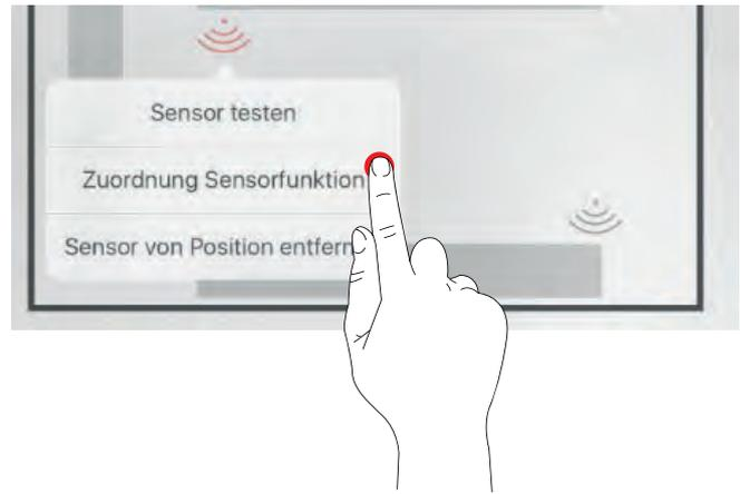
Im Fall des Use Case „Universal“ sind an dieser Stelle die gewünschten Sensorfunktionen zuzuweisen. In den Fällen vordefinierter Use Cases können die Sensorfunktionen bei Bedarf hier angepasst werden.
