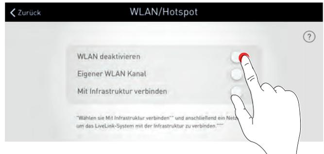
In diesem Pop-Up muss die Dekaktivierung bestätigt werden. Wenn anschließend die Verbindung zur zugreifenden App unterbrochen wird, verbleibt die WLAN-Schnittstelle des Steuergerätes noch für 10 Minuten aktiv und schaltet dann ab.
