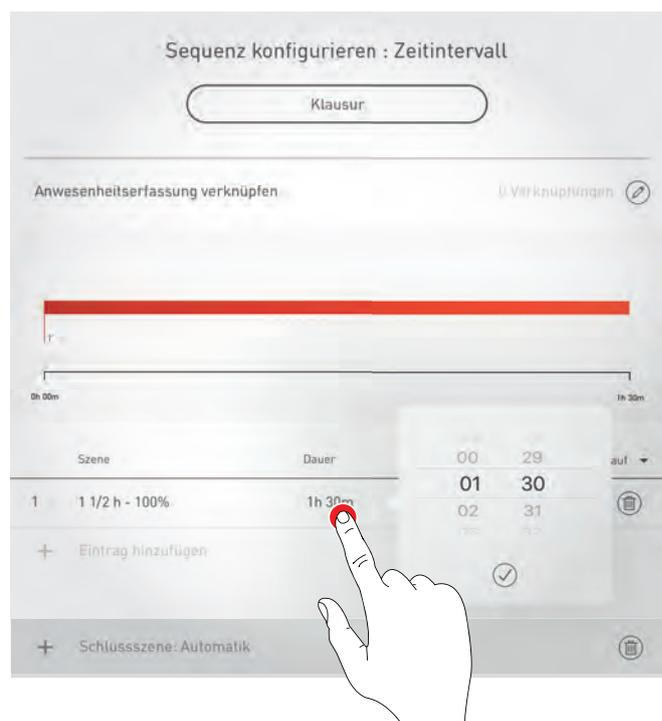
Für eine **Zeitintervall**-Sequenz kann eine **Anzahl der Durchläufe** oder alternativ eine **Endlosschleife** (ohne Schluss-Szene) festgelegt werden.
