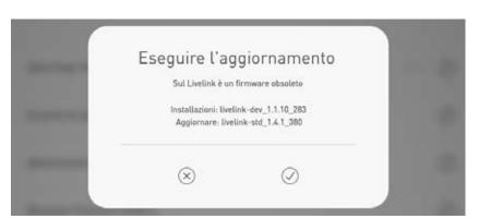
Dopo la conferma, il firmware è caricato nel sistema e poi installato sull'unità di controllo ("LiveLink flashing").
